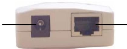
Verbinden Sie den Netzwerkanschluß des POE- Spannungsteilers mit dem Netzwerkanschluß eines Routers, bzw. Switches.
