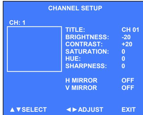
Betätigen Sie die Tasten "▲" und "▼", um das Menü zu wählen. Mit "ENTER" öffnen Sie das Menü.
