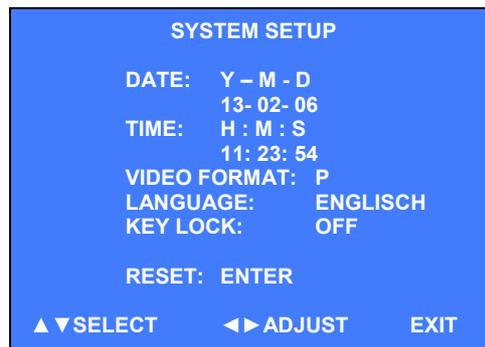
Betätigen Sie die Tasten "▲" und "▼", um das Menü zu wählen. Mit "ENTER" öffnen Sie das Untermenü und können hier Uhrzeit, Datum, Fernsehnorm, Adresse und die Tastensperre einstellen. Außerdem besteht hier die Möglichkeit, das Gerät in die Werkseinstellungen zurückzusetzen. Verlassen Sie das Menü mit Betätigung der Taste "MENU".
