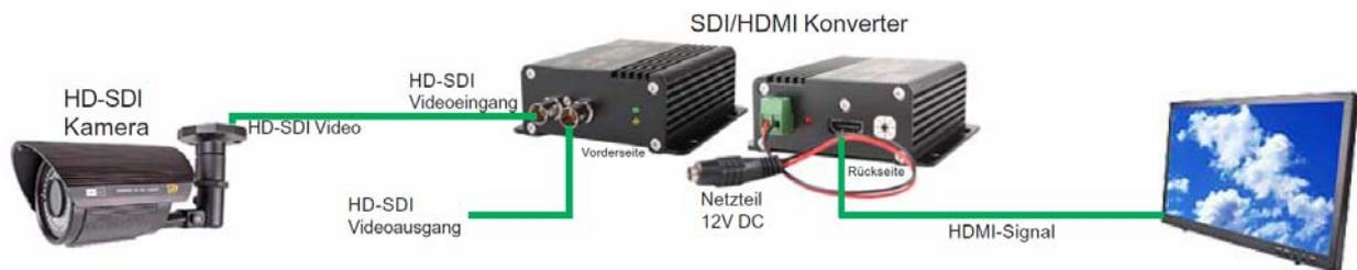
1. Verbinden Sie den Anschluß „SDI-IN“ mit dem HD-SDI Videoausgang einer HD-SDI Kamera.
