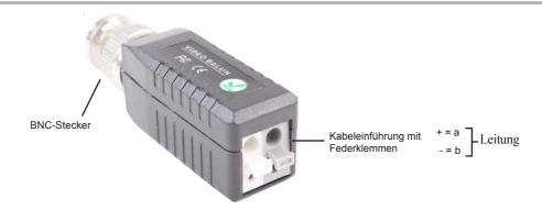
Zum Anschluß eignen sich alle verdrallten Fernmeldekabel. Durch ein mehrpaariges Kabel können mehrere 2-Drahtstrecken geführt werden, wenn bei allen Strecken das Videosignal im Kabel in dieselbe Richtung übertragen wird und in einen Viererdrall nur jeweils ein Kabelpaar für die Videoübertragung benutzt wird.
