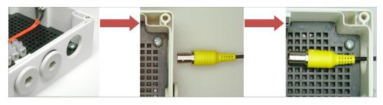
1. Stecker in den Anschlußkasten führen 2. Gummitülle mit dem Kabel verbinden und fest in die Öffnung pressen.
