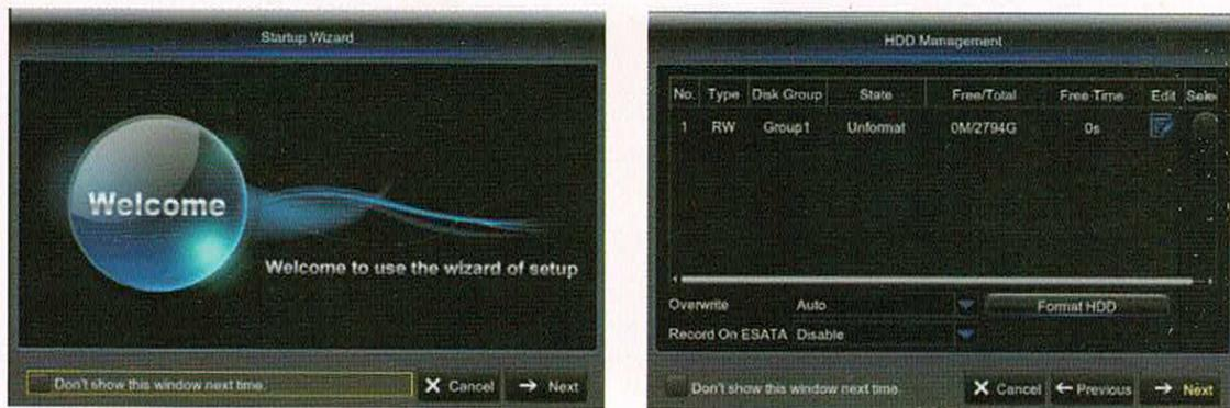
Um eine eingebaute Festplatte zu nutzen, muss diese formatiert werden. Wählen Sie die Festplatte hier aus und betätigen Sie den Button „Format HDD“. Anschließend können Sie die Netzwerk- sowie ggf. die E-Mail-Konfiguration durchführen. Im nächsten Fenster können Einstellungen zu den IP-Kameras durchgeführt werden. Darauffolgend ist es möglich generelle System-Konfigurationen, wie Datum, Uhrzeit, Sprache, usw., durchzuführen.
