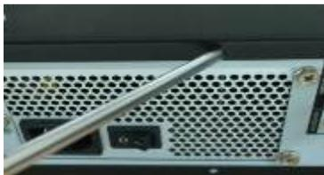
1. Lösen Sie die Schrauben der oberen Abdeckung und nehmen Sie die Abdeckung ab.
