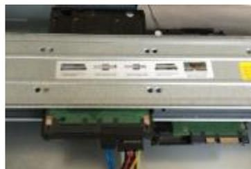
5. Schließen Sie das Stromkabel der Festplatte an.
