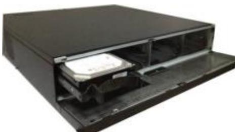
3. Setzen Sie die Festplatte in den Clip ein und verstellen Sie den Griff der Festplatte, um sie zu sichern.
