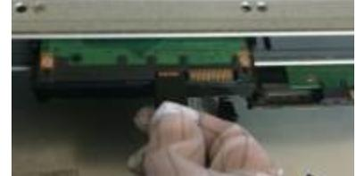
3. Schließen Sie das Datenkabel der Festplatte an einer Festplatte an.
