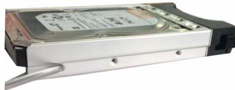
2. Setzen Sie die Festplatte in das Gehäuse ein und schrauben Sie sie fest.
