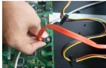
5. Verwenden Sie das spezielle Datenkabel, um Festplatte und SATA-Port zu verbinden.
