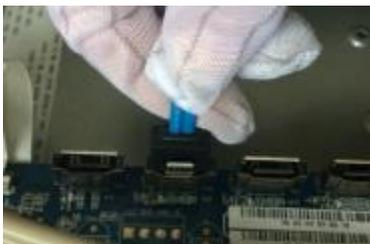
4. Schließen Sie das andere Ende des Datenkabels der Festplatte an der Hauptplatine an.
