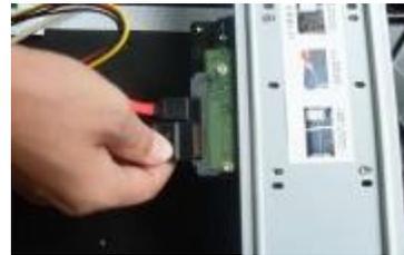
6. Schließen Sie das Stromkabel der Festplatte an, dann setzen Sie die Abdeckung zurück. Ziehen Sie die Schrauben fest an.
