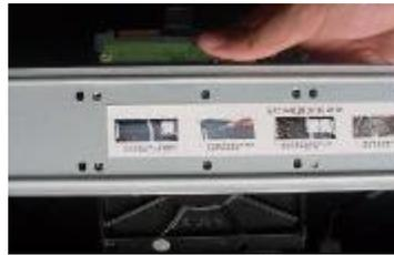
2. Richten Sie die Festplatte mit den vier Bohrungen im Boden aus.
