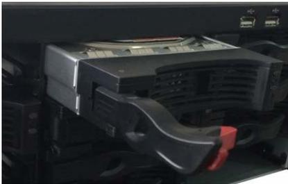
3. Setzen Sie das Festplattengehäuse im Gerät ein. Achten Sie darauf, dass der Handgriff des Festplattengehäuses oben ist, damit er nicht gegen die Frontblende stößt.
