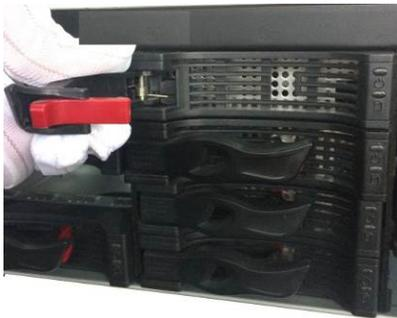
1. Entfernen Sie das Festplattengehäuse vom Gerät.
