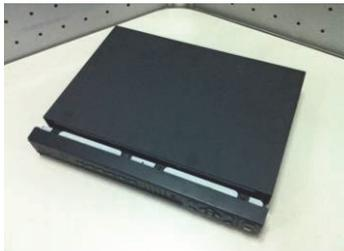
⑦ Richten Sie die obere Abdeckung an der Klemme aus, um sie zurückzusetzen.
