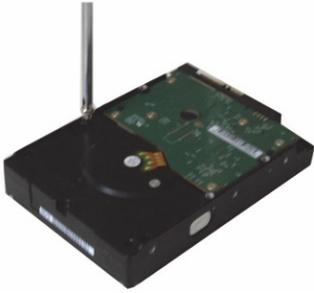
④ Befestigen Sie vier Schrauben in der Festplatte (Nur drei Umdrehungen). Richten Sie die Festplatte an den vier Bohrungen am Boden aus.
