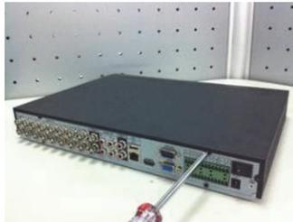
⑧ Sichern Sie die Schrauben an der Rückplatte und an der Seitenverkleidung.
