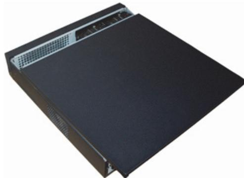
④ Nachdem Sie das Kabel angeschlossen haben, setzen Sie die Frontabdeckung zurück auf das Gerät und ziehen Sie die vier Schrauben an der Rückplatte an.
