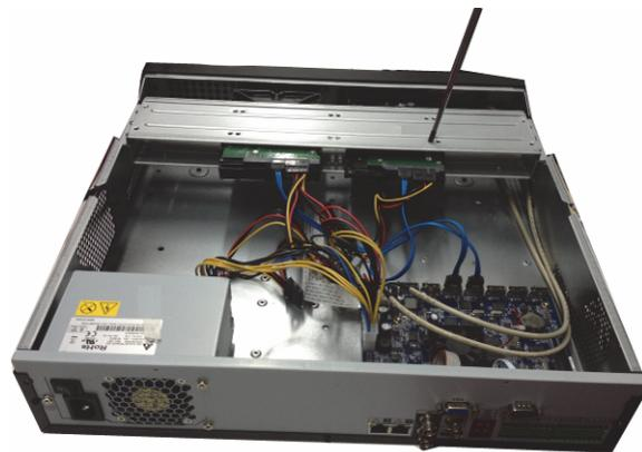
② Platzieren Sie die Festplatte auf der Festplattenhalterung im Gehäuse, dann richten Sie die vier Schrauben mit den vier Bohrungen an der Festplatte aus. Um die Festplatte auf der Halterung zu sichern, befestigen Sie die Schrauben gut mit einem Schraubendreher
