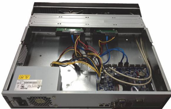
③ Verbinden Sie das Festplattenkabel mit der Hauptplatine bzw. mit dem Festplattenanschluss. Lockern Sie das Netzkabel des Gehäuses und verbinden Sie das andere Ende des Netzkabels mit dem Festplattenanschluss.
