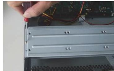
⑥ Bringen Sie die obere Halterung an, befestigen Sie dann die Festplatte mit vier Schrauben auf der Halterung.
