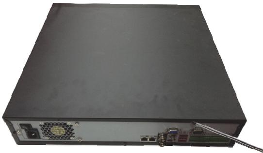
① Mit einem Schraubendreher lösen Sie die Schrauben an der Rückplatte, dann entfernen Sie die Frontabdeckung.
