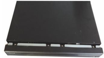
⑥ Richten Sie die obere Abdeckung an der Klemme aus, um sie zurückzusetzen. Sichern Sie die Schrauben an der Rückplatte und an der Seitenverkleidung.
