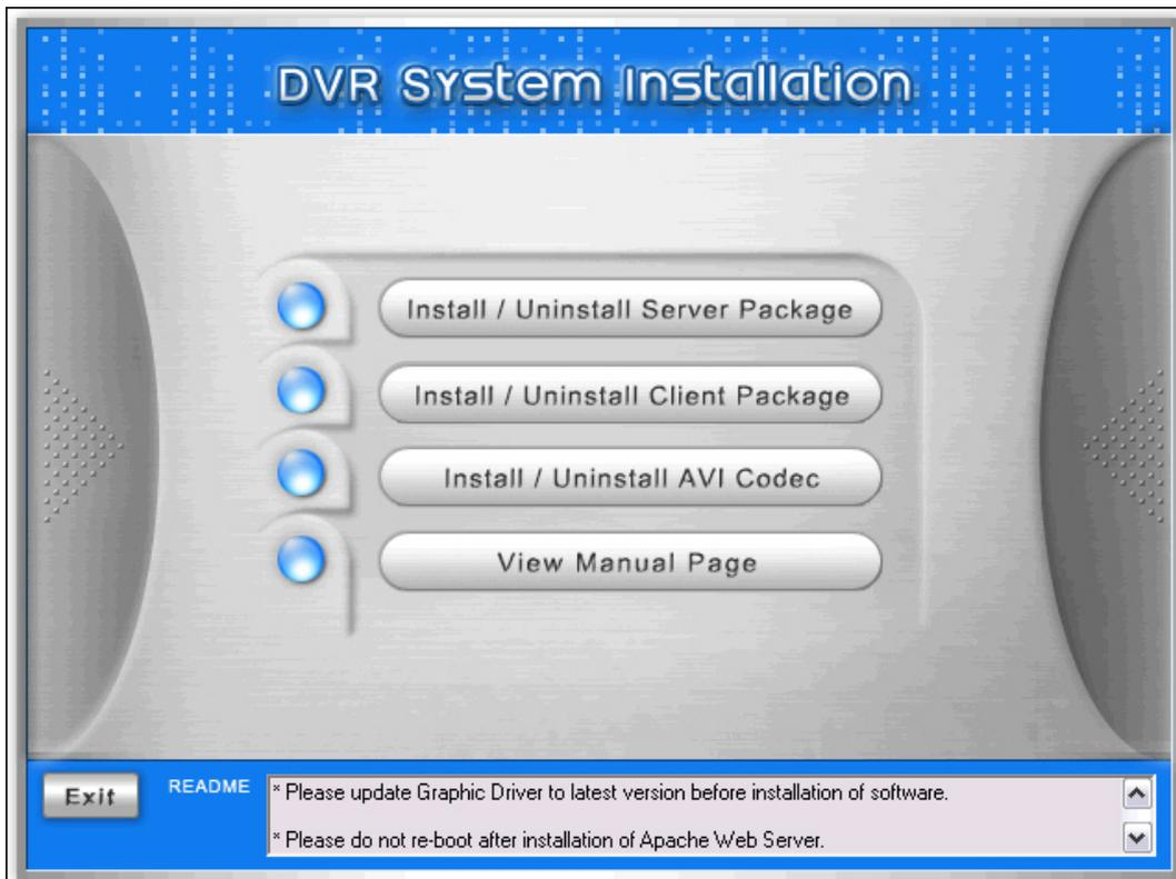
Klicken Sie den Button „Install/Uninstall Server Package“ an. Daraufhin wird mit der Installation der Programme Apache Web Server, Web Client und DVR Server fortgefahren.
