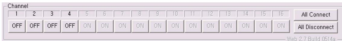
Im Menü „Channel“ können die Videoeingänge gewählt werden, die gleichzeitig übertragen werden sollen. Dabei sollten so wenig Kamerasignale wie möglich parallel übertragen werden, um die Belastung des Netzwerks gering zu halten.
