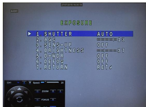
Betätigen Sie den Button „Pfeil nach unten“ bis der Punkt 7 „Return“ erreicht ist und bestätigen Sie mit „IRIS+“, um das Kameramenü zu verlassen.
