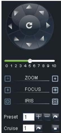
Über die Betätigung der Pfeiltasten wählen Sie die Richtung, in die sich die steuerbare Kamera bewegen soll. Der mittlere Button dient dazu, eine Autotour zu starten.
