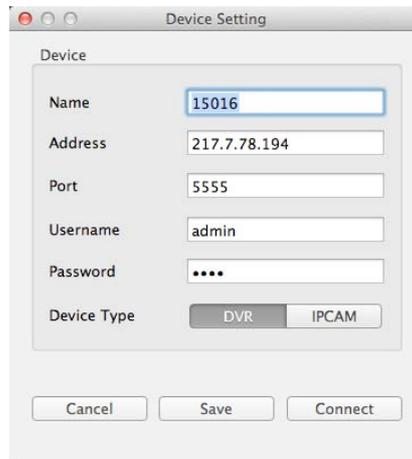
Die Einstellungen können durch den Button „Save“ gespeichert werden. Außerdem ist nun der Verbindungsaufbau zu dem DVR möglich. Bei erfolgreicher Verbindung zeigt die Software die Livebilder der an dem Rekorder angeschlossenen Kameras an.
