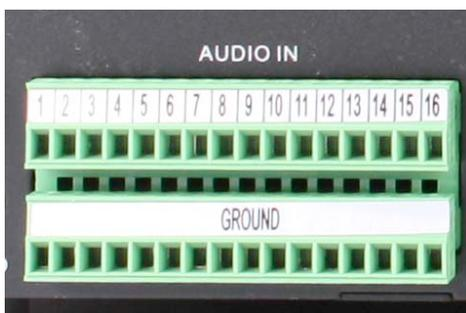
Schliessen Sie das heiße Ende (+) des Mikrofons an den entsprechenden Audioeingang an. Den Gemeinsamen (-) klemmen Sie bitte an den entsprechenden Kontakt der unteren Leiste. Die Audioeingänge 1-16 korrespondieren mit den Videoeingängen 1-16.
