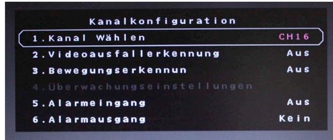
Wählen Sie das Menü „Kanalkonfiguration“ und drücken Sie die Taste „ENTER“. In diesem Menü stellen Sie alle, die einzelnen Eingangskanäle betreffenden Parameter im Aufzeichnungsmodus ein.
