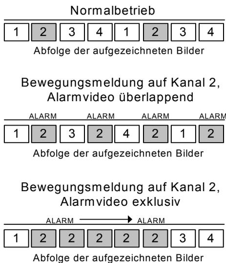
Abbildung 9 – Aufzeichnungsdetails für eine Installation mit vier Kameras
