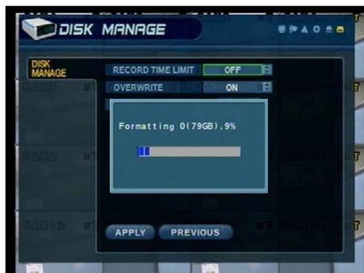
• Record Time Limit: Maximale Aufnahmedauer. Ist diese Aufnahmedauer überschritten werden alle Aufzeichnungen angehalten und der Systemsummer ertönt. Die Aufzeichnungen können wieder gestartet werden, nachdem Record Time Limit ausgeschaltet wird (OFF) oder die Festplatte gelöscht (Format) wurde.
