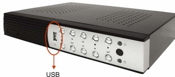
Innerhalb des gewählten Ereignisses aus der Liste können Sie die Startzeit und Endzeit manuell verändern und dann ein entsprechendes Speichermedium mit der USB Schnittstelle an der Vorderseite des Gerätes anschliessen.
