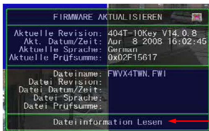
Wenn die Datei oder der USB Stick fehlerhaft sind, erscheinen die Meldungen "Datei nicht gefunden" bzw "Laufwerk fehlerhaft".
