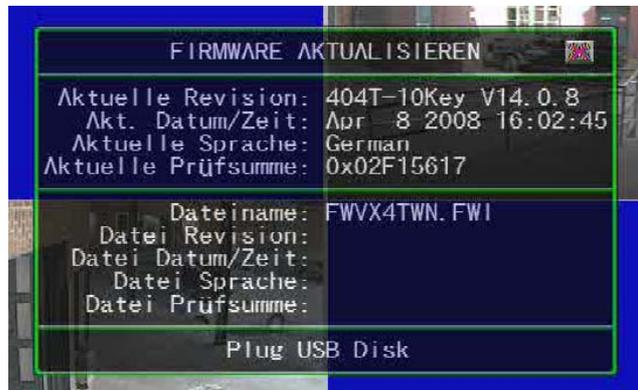
Stecken Sie den USB-Stick, auf dem sich die Datei mit der aktuellen Firmware befindet, in den USB-Port an der Vorderseite des Rekorders.
