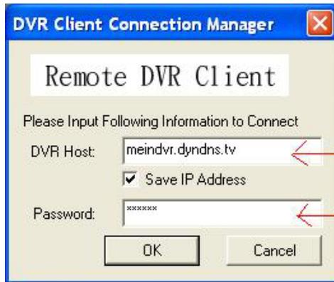
**Nachdem Sie bei der Software auf Connect gedrückt haben erscheint das Verbindungsfeld. Geben Sie hier unter DVR Host den von Ihnen festgelegten Domainnamen an. Tragen Sie unter Password das im DVR eingestellte Passwort ein. Drücken Sie OK um die Verbindung zu dem Rekorder aufzubauen**
