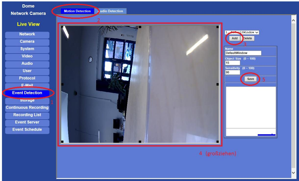
Zusätzlich im NVR unter „Aufnahme“ den „Zeitplan“ für die Kamera entsprechend auf Bewegungserkennung stellen und die Kamera im Menü „Alarm“ unter „Bewegung“ den Haken für Aktiv setzen.
