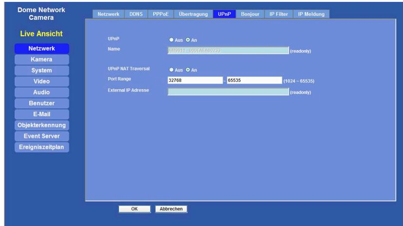
Der Dienst „UPnP“ dient dazu, dem Netzwerk neu hinzugefügte Netzwerkkamera selbstständig zu erkennen und der Liste der Netzwerkkamera hinzuzufügen. Dazu muss sowohl die UPnP Funktion in der Software (An) als auch in den Netzwerkeinstellungen ihres Betriebssystems aktiviert sein.
