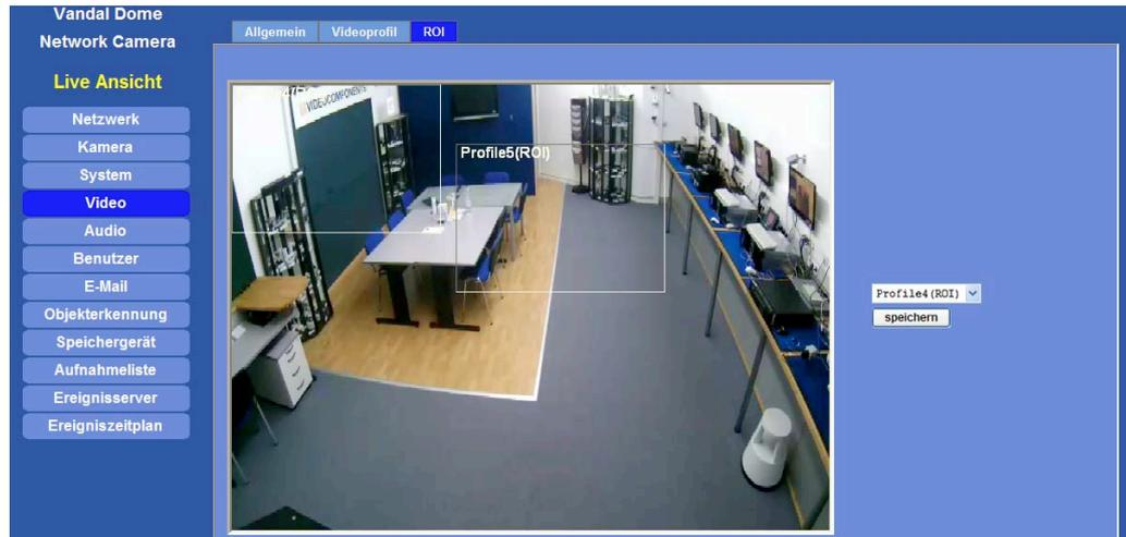
Sobald im Menü „Videoprofil“ in einem Profil „ROI“ mit „Ja“ aktiviert wurde, steht dieses Profil in der Drop Down Liste hier zur Verfügung und die entsprechenden Zone, deren Inhalt in besserer Qualität übertragen werden sollen, kann konfiguriert werden. Betätigen Sie den Button „speichern“ nachdem das Feld gesetzt wurde.
