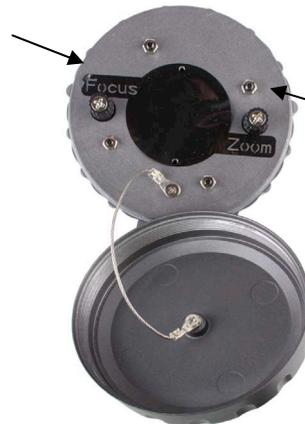
Zoom Einstellschraube (Hier erfolgt die Einstellung des Blickwinkels mittels eines Kreuzschraubendrehers oder von Hand.)
