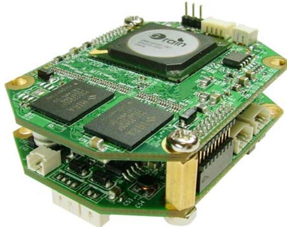
Der Netzwerk-Videoserver ermöglicht jede beliebige analoge Videokamera in ein digitales Netzwerk (LAN bzw. WAN) zu stellen.
