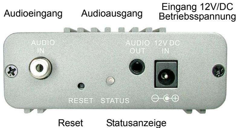
**RESET**      Um die Werkseinstellungen wieder herzustellen, betätigen Sie den Taster hinter der Reset-Öffnung mit einer Kugelschreiberminie oder ähnlichem. Halten Sie die Taste für ca 3 Sek. gedrückt. Starten Sie jetzt das Gerät neu. Die Werkseinstellungen sind wieder hergestellt.
