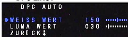
Sollte die Kamera über einzelne defekte Pixel verfügen, kann im Menü DPC EINST (DEAD PIXEL CANCELLATION) ein Angleichen des Helligkeitswertes des defekten Pixels an die Helligkeit der Bildumgebung stattfinden.
