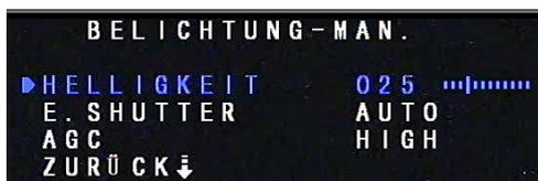
**HELLIGKEIT** Hier wird elektronisch ein fester Blendenwert eingestellt, der bei Betrieb mit einem manuellen Objektiv gilt.
