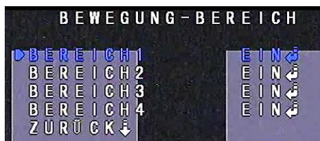
Bestätigen Sie „BEREICH“. Durch drücken des „Joysticks“. Wählen Sie den einzurichtenden Bereich. Es besteht die Möglichkeit, bis zu 4 Bereiche im Bild auszuwählen, in denen Bewegung detektiert werden soll. Bereiche, die nicht genutzt werden, können mit „AUS“ deaktiviert werden.
