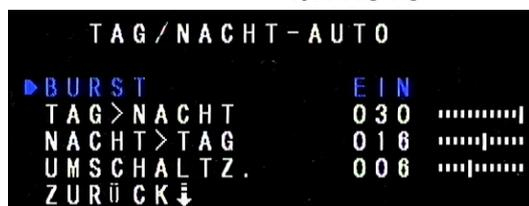
Kamera schaltet den Beleuchtungsverhältnissen entsprechend zwischen Farb- und S/W-Bild um und schwenkt im Nachtbetrieb (S/W) den IR-Sperrfilter weg. Im Nachtbetrieb wird die Kamera IR-tauglich und lichtempfindlicher. Bestätigen Sie im Betrieb „AUTO“ durch Drücken des Joysticks, erscheint dieses Untermenü:
