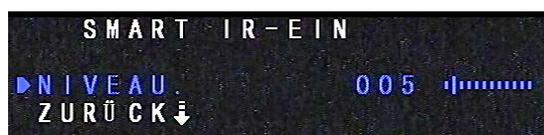
Im SMART IR Modus besteht die Möglichkeit, die Beleuchtungsverhältnisse bei IR-Beleuchtung in einem einstellbaren Bereich von 0-30 so anzugleichen, das keine überstrahlten Objekte im Bild erscheinen.
