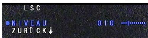
**EIN** Im LSC Modus (Lens Shading Compensation) besteht die Möglichkeit, den dunkler erscheinende Randbereich des Bildes in einem einstellbaren Bereich von 0-30 anzugleichen, um eine größere Detailerkennung im Randbereich zu ermöglichen.
