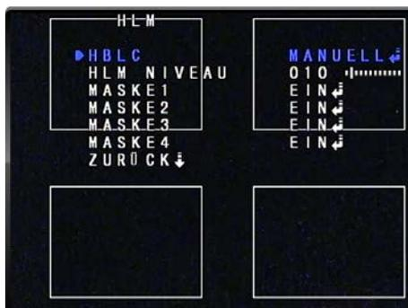
**D-WDR** Hier erfolgt eine Angleichung der hellen und dunklen Bildbereiche aneinander, wodurch eine bessere Detailerkennung sowohl in den Schatten- als auch in den Spitzlichtbereichen ermöglicht wird. Über den Menüpunkt NIVEAU bestimmen Sie den Anteil der Angleichung.
